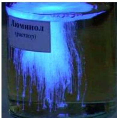
Рисунок 1.21 – Приклад фотохімічної реакції при взаємодії складної органічної сполуки люминолу \text{C}_8\text{H}_7\text{N}_3\text{O}_2 з окисником у лужному середовищі
