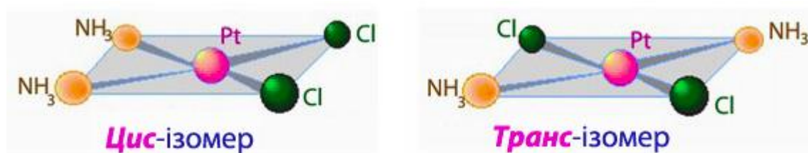
Рисунок 13.8 – Геометричні ізомери комплексу [PtCl_2(NH_3)_2] , що має квадратну будову
