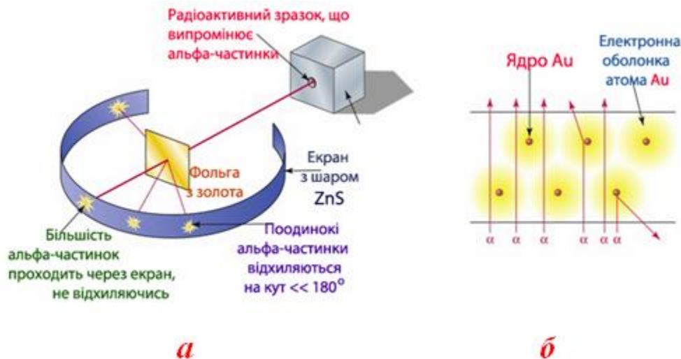
Рис. 2.8 – Досліди Резерфорда: а) схема пристрою: у камері, закріпленій на поворотному диску, знаходиться радіоактивний зразок (препарат) Радію, який випромінює \alpha -частинки (тобто ядра атомів Гелію), що бомбардують тонку золоту фольгу. Альфа-частинки, які пролітають через фольгу зі швидкістю 10000 км/с, відхиляються атомами Ауруму на різні кути і потрапляють на екран, вкритий шаром ZnS, викликаючи сцинтиляції (спалахи). Кількість спалахів реєструється за допомогою мікроскопу. Протягом дослідів зафіксовано більше 100 тис. сцинтиляцій і встановлено, на кут 180^\circ (в протилежному напрямку відносно \alpha -випромінювання) відхиляється тільки одна частинка з 8 тис. Експеримент підтвердив, що \alpha -частинки відштовхуються ядром Au відповідно до закону Кулона; б) модель руху \alpha -частинок поблизу атомів Au
