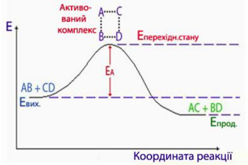
Рисунок 7.11 – Енергетична діаграма реакції AB+CD\rightarrow AC+BD , де E_A – енергія активації, E_{\text{вих.}} і E_{\text{прод.}} – середня енергія вихідних реагентів і продуктів реакції відповідно
