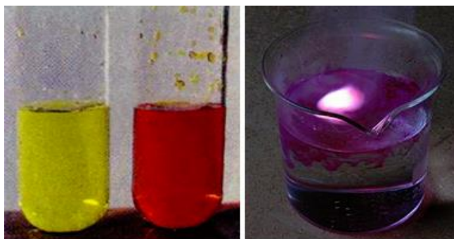
Рисунок 7.2 – Ілюстрація до класифікації хімічних реакцій за фазовим складом: а) гомогенна реакція по перетворенню \text{K}_2\text{CrO}_4 \rightarrow \text{K}_2\text{Cr}_2\text{O}_7 (у пробірці ліворуч – вихідний розчин \text{K}_2\text{CrO}_4 жовтого кольору, праворуч – продукт реакції \text{K}_2\text{Cr}_2\text{O}_7 оранжевого кольору); б) гетерогенна реакція між натрієм і водою (додавання індикатора фенолфталеїну зумовлює появу малинового забарвлення, що вказує на утворення луку NaOH)
