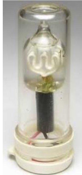
Рисунок 11.21 – Зовнішній вигляд одного з типів хемотронів
