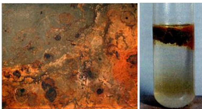
Рисунок 12.2 – Продукти корозії заліза: а) іржа; б) первинний продукт корозії
