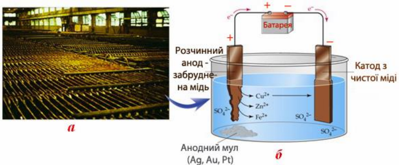
Рисунок 11.17 – Електролітичне рафінування міді: а) виробничий процес рафінування; б) схема процесу
