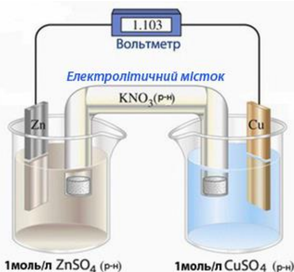
Рисунок 11.9 – Гальванічний елемент Якобі-Даніеля
