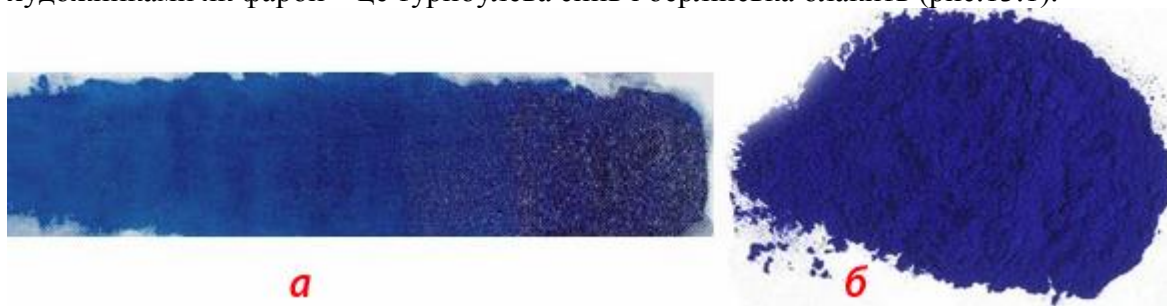
Рисунок 13.1 – Комплексні сполуки: а) турнбулева синь \text{Fe}_3[\text{Fe}(\text{CN})_6]_2 ; б) берлінська блакить \text{Fe}_4[\text{Fe}(\text{CN})_6]_3
