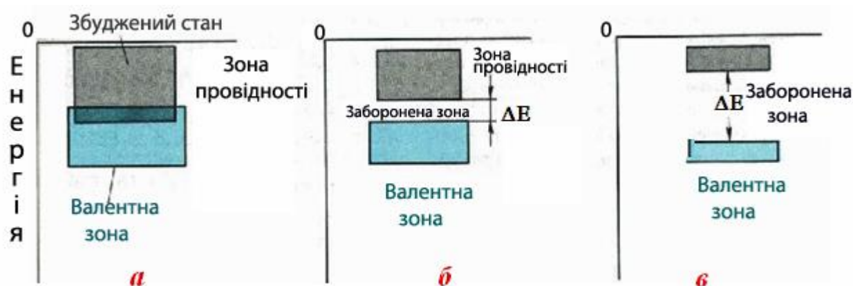
Рисунок 5.21 – Заповнення енергетичних зон електронами: а) провідники; б) діелектрики; в) напівпровідники
