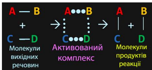
Рисунок 7.10 – Схема перебігу реакції AB+CD \rightarrow AC+BD через активований комплекс ABCD^*
