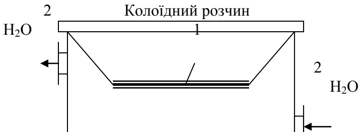
Рисунок 1 – Схема діалізатора: 1) напівпропускна мембрана; 2) чистий проточний розчинник
