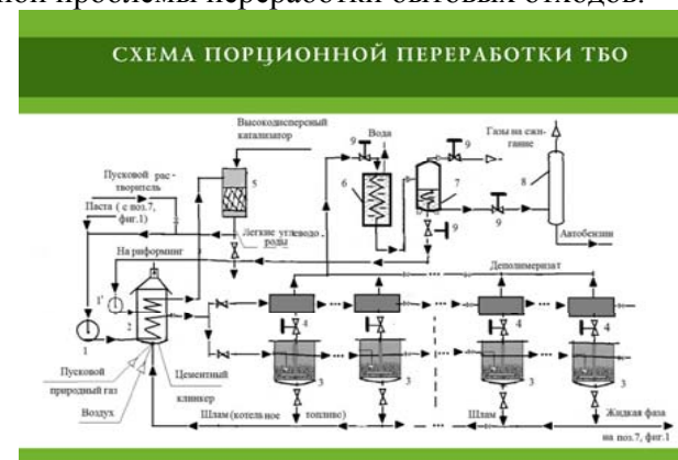
Рисунок 2. Схема порционной переработки ТБО
