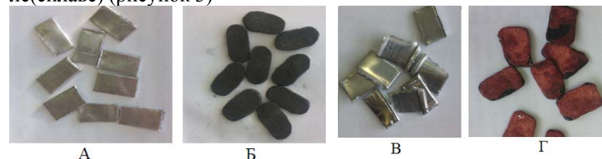
Рисунок 3. Фотографии раздробленного алюминия (ГОСТ 18482-79) до (А, В) и после (Б, Г) контакта с реакционной смесью, содержащей CoCl_2 (Б) и CuCl_2 (Г)
