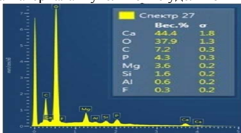
Рисунок 3. Энергодисперсионный спектр TMSO 600
