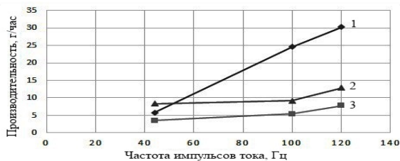
Рисунок 2. Зависимость производительности ЭД отходов меди от частоты следования импульсов в различных средах: 1 – вода; 2 – n-бутиловый спирт; 3 – керосин
