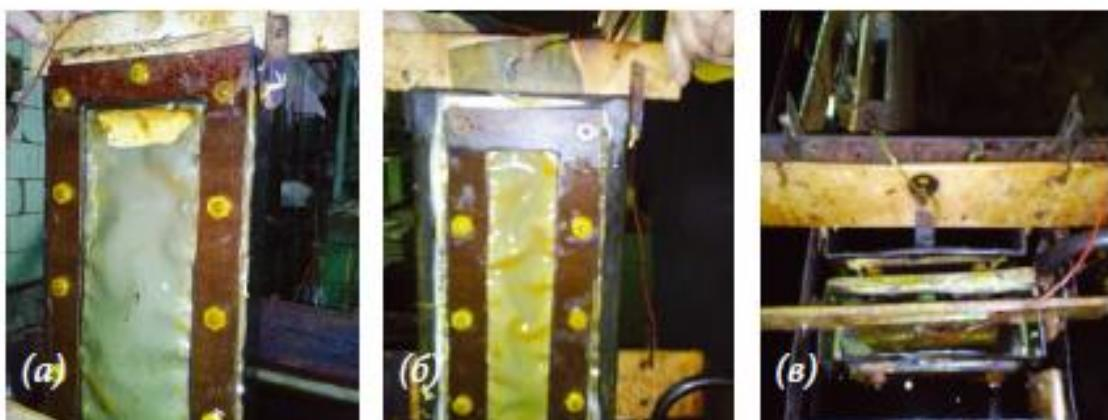
Рисунок 7. Внешний вид анионного мембранных электролизера МЭХ<sub>4</sub>, расположенного в ванне промывки деталей (ванне упаковки) после этапа пассивации. а) со стороны катодной камеры; б) со стороны раствора; в) трехкамерный модуль
