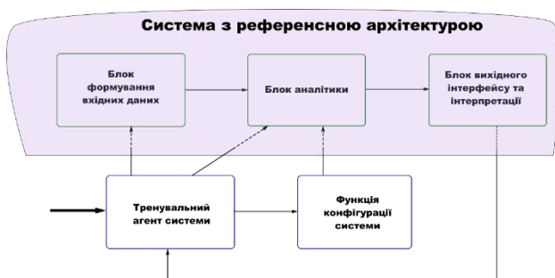
Рисунок 1 – Архітектура побудови універсальної системи з підтримкою переконфігурації
