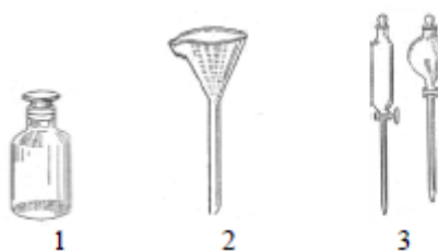
Рис. 2. Товстостінний хімічний посуд. 1 - банка (склянка) для зберігання речовин, 2 - конічна воронка, 3 - ділильні воронки
