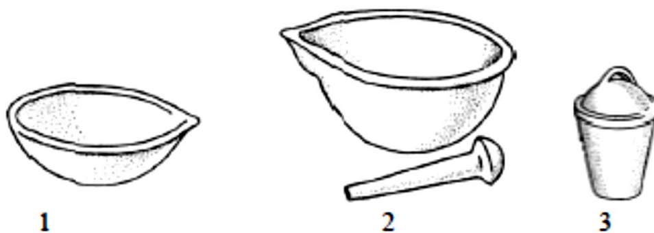
Рис.5 Фарфоровий посуд. 1 - чашка для випарування; 2 - ступка з товкачиком (макогінчиком); 3 – тигель.
