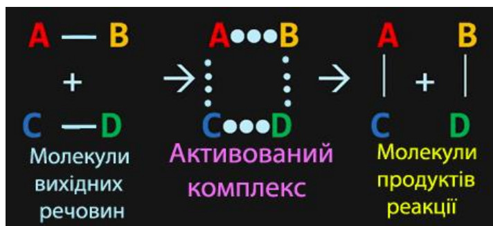
Рисунок 7.10 – Схема перебігу реакції AB + CD \rightarrow AC + BD через активований комплекс ABCD^*
