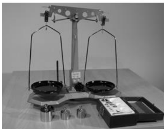
Рисунок 2 – Техно-хімічні терези: а) зовнішній вигляд; б) спрощена схема: 1 – висок; 2 – настановні гвинти; 3 – аретир; 4 – чашки для зважування; 5 – коромисло; 6 – гвинти для регулювання; 7 – стрілка; 8 – шкала
