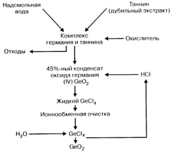
Рисунок 7.11 - Схема выделения оксида германия из надсмольной воды
