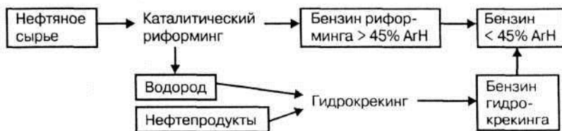
Рис. 8.10 - Схема корректировки состава бензина риформинга
