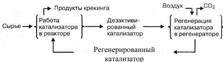
Рис. 8.8 - Схема действия катализатора при крекинге
