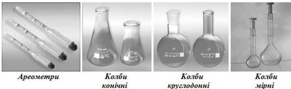
Рисунок 4 – Набір ареометрів і хімічний посуд
