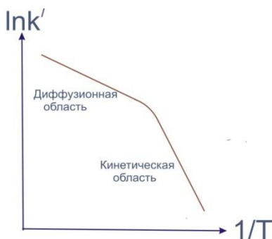
Рисунок 12.3 – Зависимость \ln k' - 1/T
