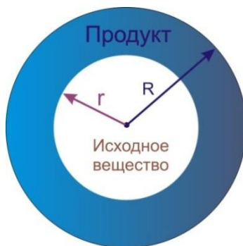
Рисунок 12.6 – Развитие топохимической реакции в зерне сферической формы
