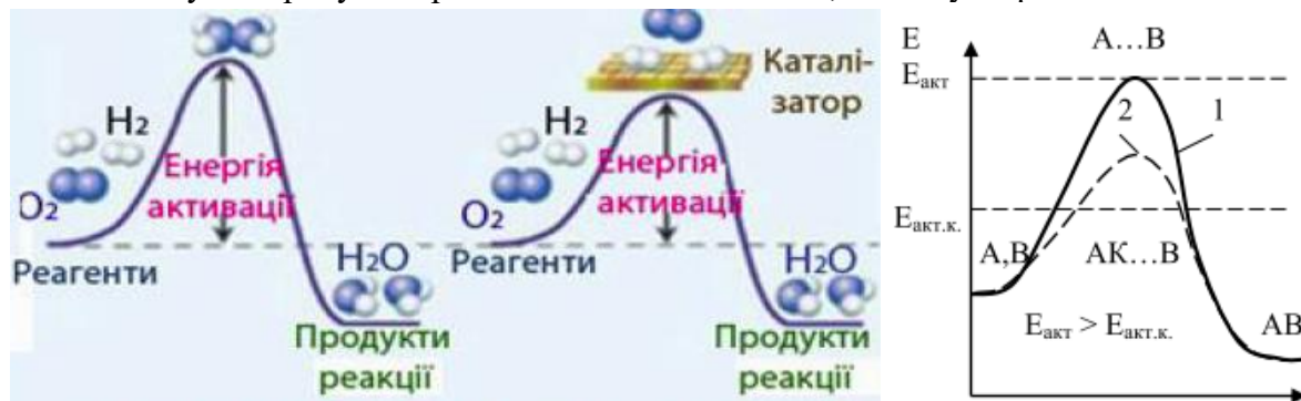
Рис.10. Енергетична діаграма для одностадійної реакції: 1 – некаталітична реакція, 2 – каталітична реакція.
