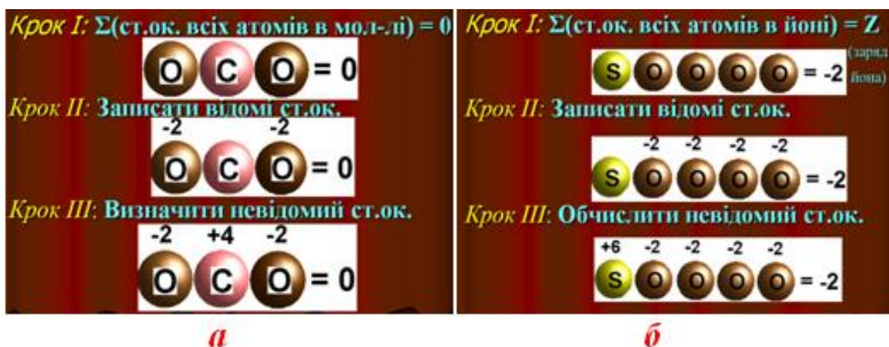
Рисунок 5.2 – Схема алгоритму визначення невідомого ступеню окиснення на прикладі молекули CO 2 та іона SO 4 2-
