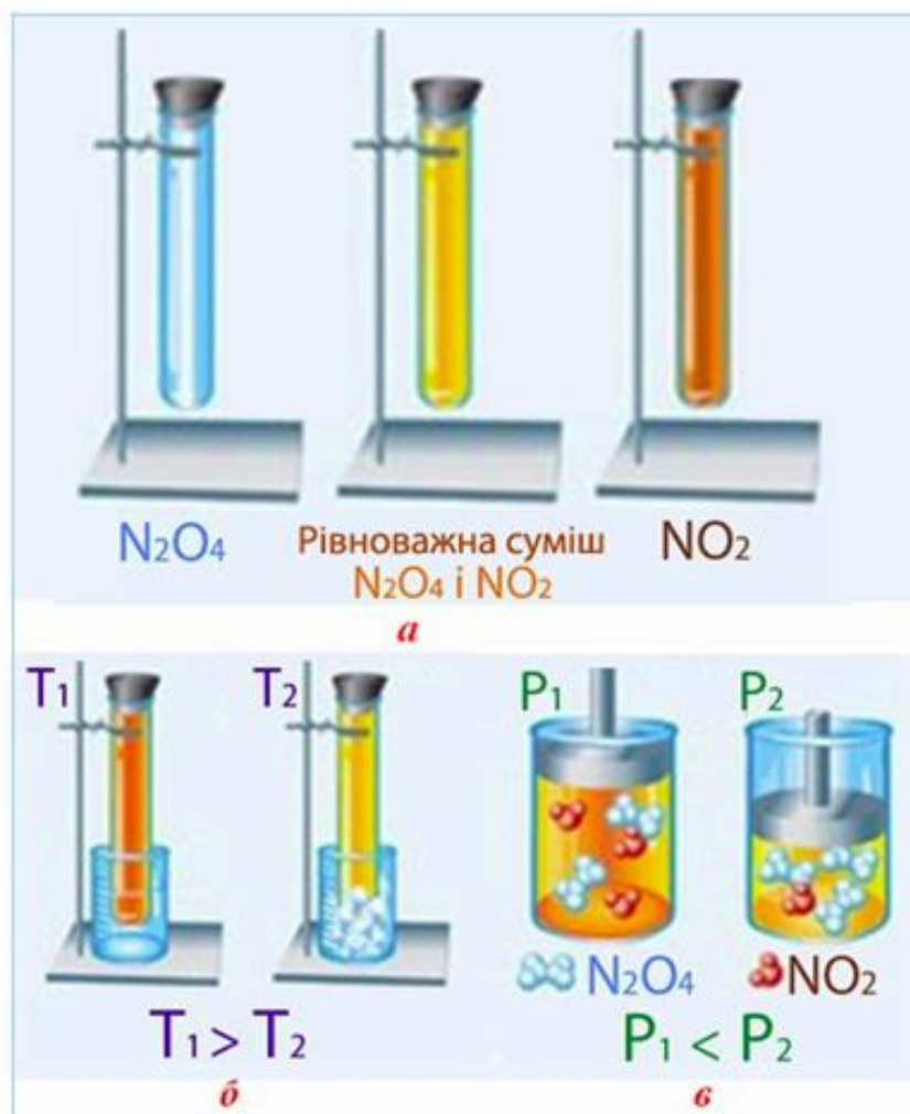
Рисунок 4.27 – Зміщення рівноваги в системі 2\text{NO}_2 \leftrightarrow \text{N}_2\text{O}_4 + Q : а) забарвлення індивідуальних газів \text{NO}_2 , \text{N}_2\text{O}_4 та їх рівноважної суміші; б) вплив температури; в) вплив тиску
