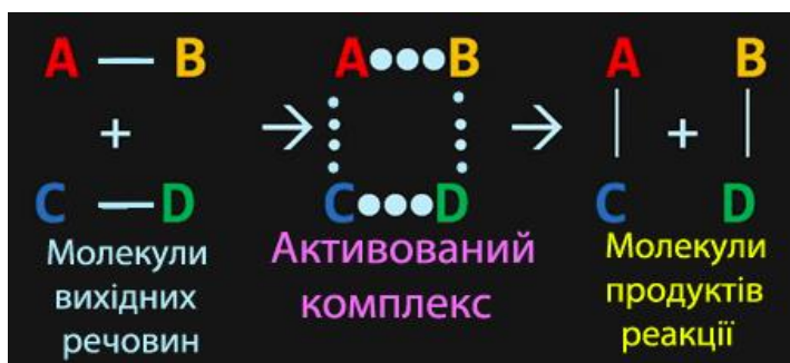
Рисунок 4.10 – Схема перебігу реакції AB+CD \rightarrow AC+BD через активований комплекс ABCD^*
