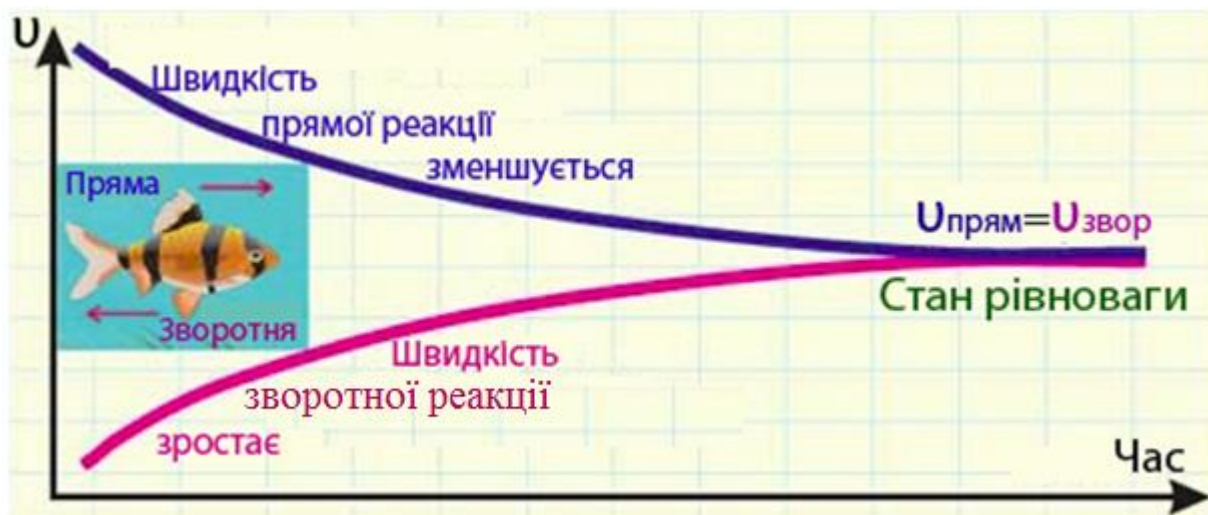
Рисунок 4.25 – Оборотні реакції: до досягнення системою стану хімічної рівноваги швидкість прямої реакції зменшується (у міру витрачання вихідних речовин), а швидкість зворотної – навпаки, зростає завдяки збільшенню концентрації продуктів реакції. Після встановлення хімічної рівноваги швидкості прямої та зворотної реакції зрівнюються
