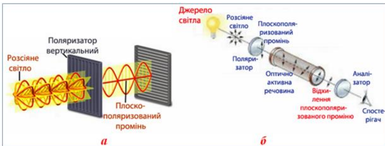
Рисунок 7.7 – Визначення конфігурації оптичних антиподів: а) утворення плоскополяризованого світла; б) змінення напрямку руху плоскополяризованого променя світла при проходженні його через розчин оптично активної речовини
