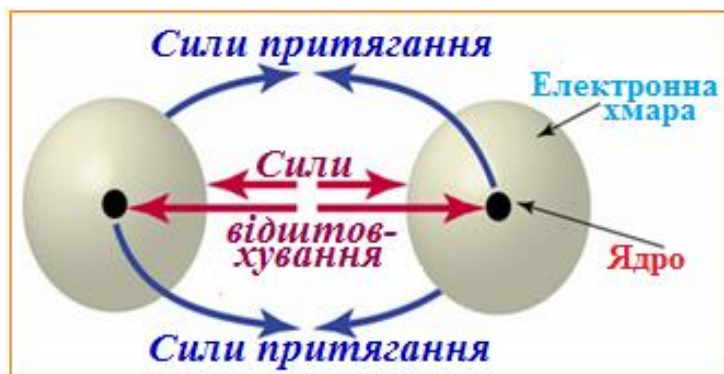
Рисунок 8.18 – Сили міжатомної взаємодії: відштовхування між електронними оболонками двох атомів та між їх ядрами; притягання між ядром одного атома і електронною оболонкою іншого і навпаки
