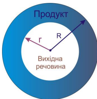
Рисунок 12.6. Розвиток топохімічної реакції в зерні сферичної форми
