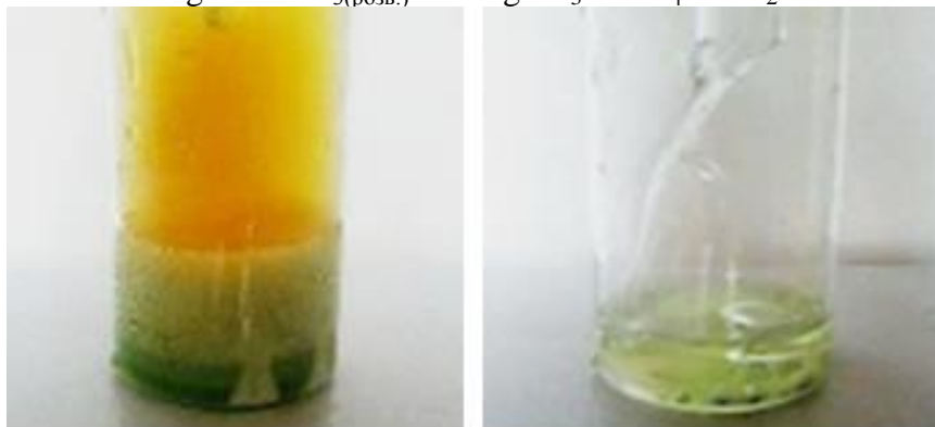
Рисунок 14.16 – Взаємодія ртуті: а) з концентрованою нітратною кислотою; б) з розведеною \text{HNO}_3
