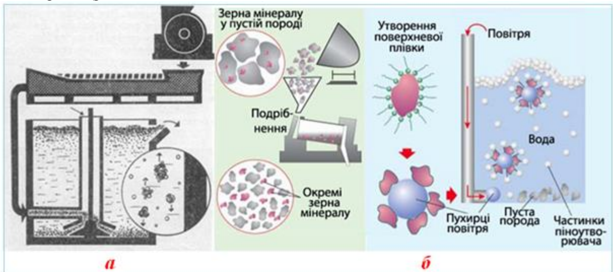
Рисунок 14.26 – Флотаційне збагачення руди: а) флотаційна машина; б) механізм збагачення
