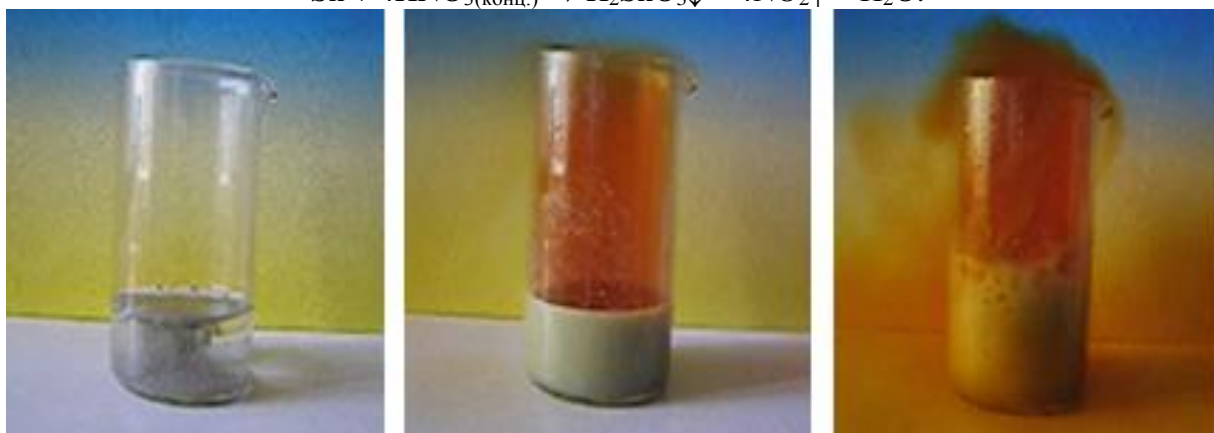
Рисунок 14.15 – Поетапна взаємодія олова Sn з концентрованою нітратною кислотою \text{HNO}_3 , внаслідок якої виділяється бурий газ \text{NO}_2
