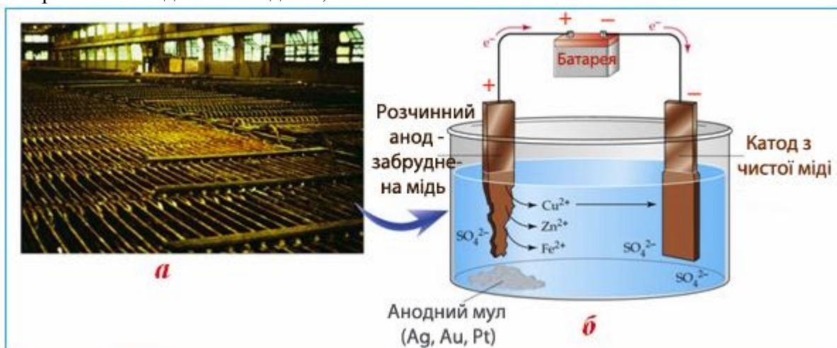
Рисунок 11.13 – Електролітичне рафінування міді: а) виробничий процес рафінування; б) схема процесу
