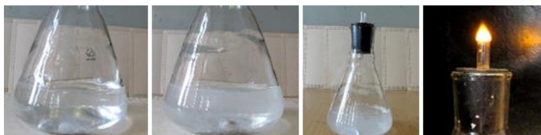
Рисунок 11.8 – Поэтапное взаимодействие Zn с раствором щелочи KOH и сгорание выделившегося водорода
