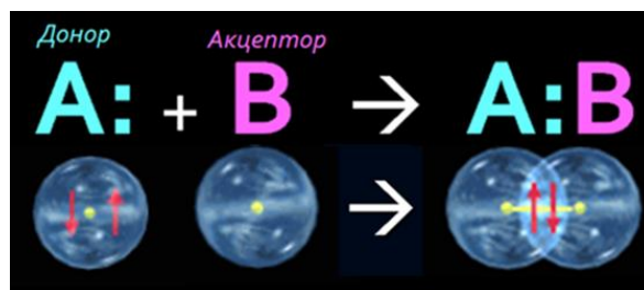
Рисунок 4.9 – Модель образования ковалентной связи по донорно-акцепторному механизму
