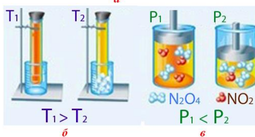
Рисунок 7.17 – Смещение равновесия в системе 2\text{NO}_2 \leftrightarrow \text{N}_2\text{O}_4 + Q : а) цвет индивидуальных газов \text{NO}_2 , \text{N}_2\text{O}_4 и их равновесной смеси; б) влияние температуры; в) влияние давления
