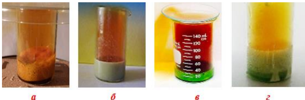
Рисунок 11.9 – Взаимодействие концентрированной HNO 3 с металлами: а) Zn; б) Sn; в) Cu; г) Hg
