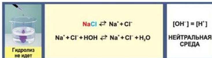
Рисунок 9.11 – Соль, образованная сильным основанием и сильной кислотой, гидролизу не подвергается
