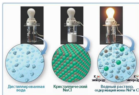
Рисунок 9.1 – Неэлектролиты: дистиллированная H_2O , кристаллический NaCl и проводник второго рода – раствор соли, в котором переносчиками электрических зарядов являются ионы Na^+ и Cl^-
