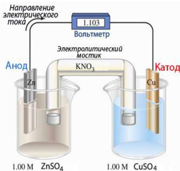
Рисунок 10.7 – Гальванический элемент Якоби-Даниэля
