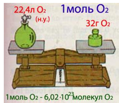
Рисунок 2.8 – 1 моль O_2 , который содержит 6,02 \cdot 10^{23} молекул и имеет массу 32 г, при нормальных условиях (н.у.) занимает объем 22,4 л
