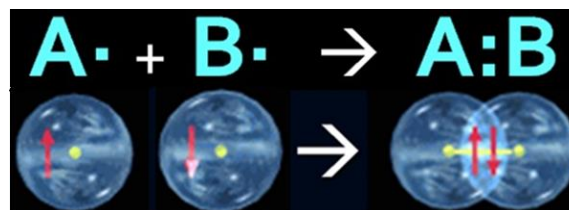
Рисунок 4.8 – Модель образования ковалентной связи по обменному механизму
