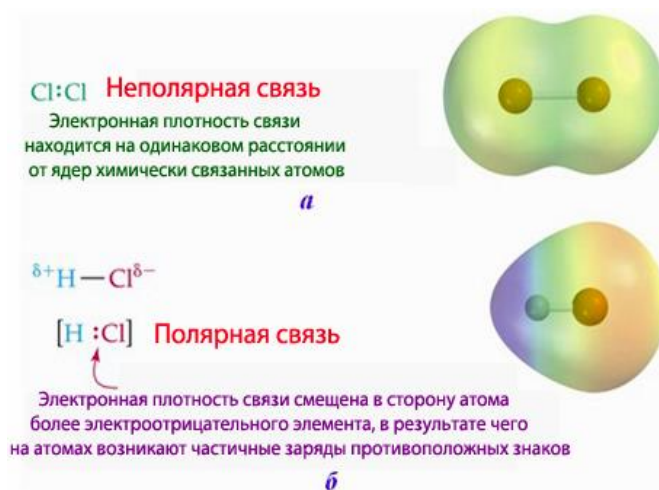
Рисунок 4.21 – Полярность ковалентной связи: а) неполярная связь в гомоядерной молекуле Cl 2 ; б) полярная связь в гетероядерной молекуле HCl
