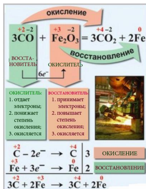
Рисунок 5.11 – Взаимозависимость процессов окисления и восстановления
