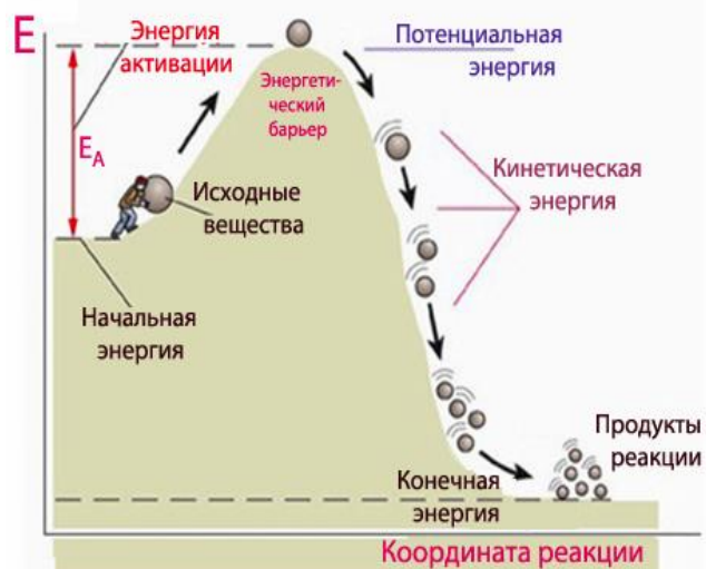
Рисунок 7.8 – Упрощенная схема хода реакции через преодоление энергетического барьера
