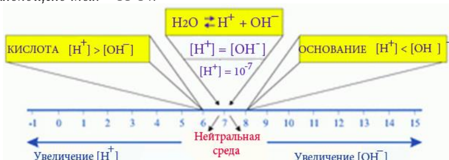
Рисунок 9.9 – Связь между кислотностью среды и значениями рН
