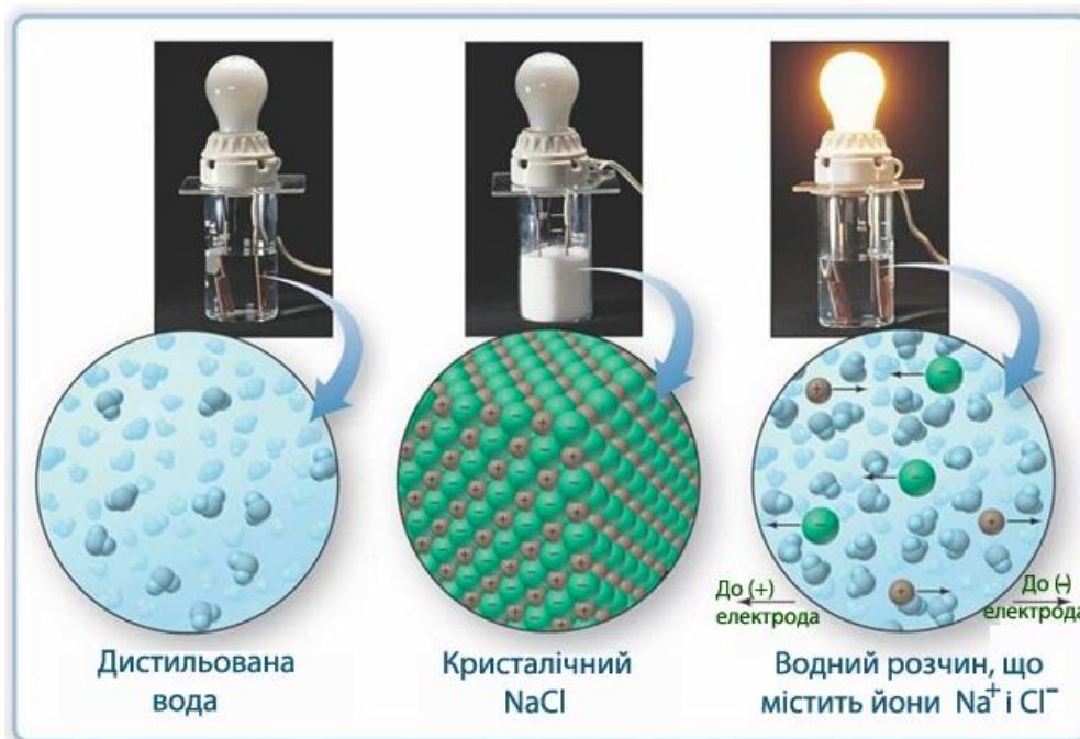
Рис.1 – Водний розчин натрій хлориду – електроліт, який проводить електричний струм за рахунок гідратованих йонів \text{Na}^+ і \text{Cl}^- .
