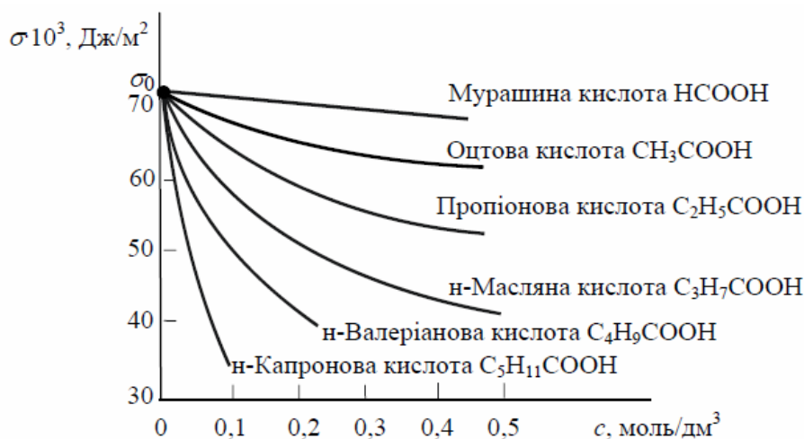
Рис.4 Ізотерми поверхневого натягу водних розчинів насичених жирних кислот
