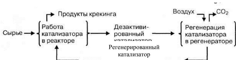
Рисунок 15.2 – Схема действия катализатора при крекинге
