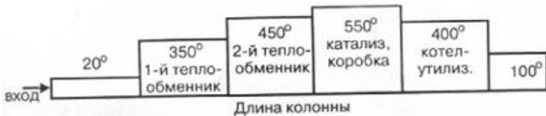
Рисунок 8.13 – График изменения температур в колонне синтеза
