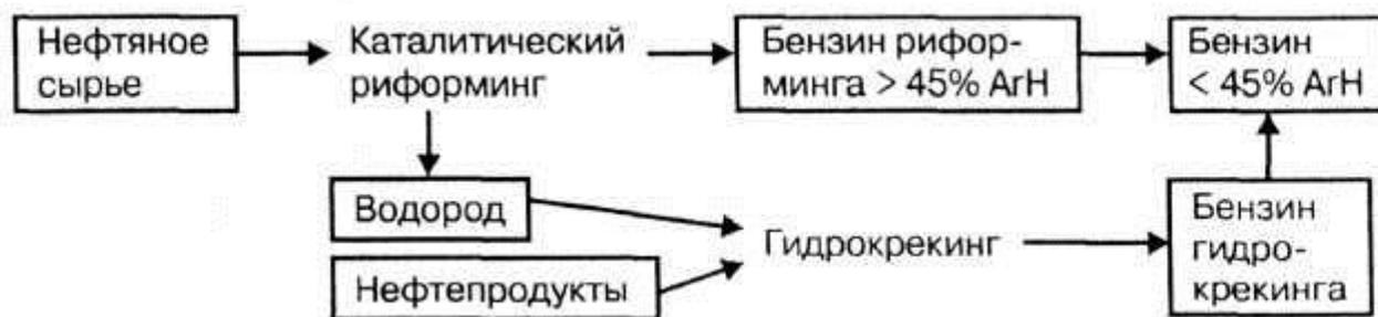
Рисунок 15.4 – Схема корректировки состава бензина
