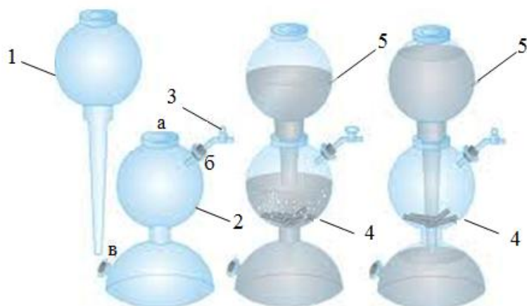
Рисунок 8 – Апарат Кіппа: 1 – лійка; 2 – посудина: а) верхній широкий отвір для закріплення лійки; б) бічний отвір із краном для виходу водню; в) нижній отвір для зливання кислоти; 3 – кран; 4 – цинк; 5 – розчин кислоти
