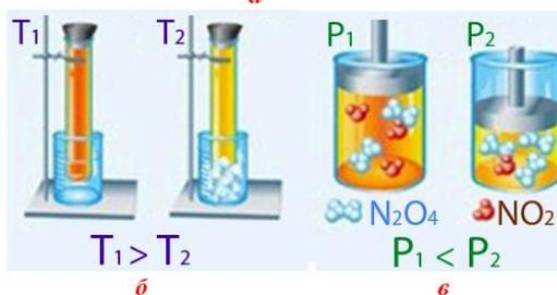
Рисунок 7.17 – Смещение равновесия в системе  $2\text{NO}_2 \leftrightarrow \text{N}_2\text{O}_4 + Q$ : а) цвет индивидуальных газов  $\text{NO}_2$ ,  $\text{N}_2\text{O}_4$  и их равновесной смеси; б) влияние температуры; в) влияние давления
