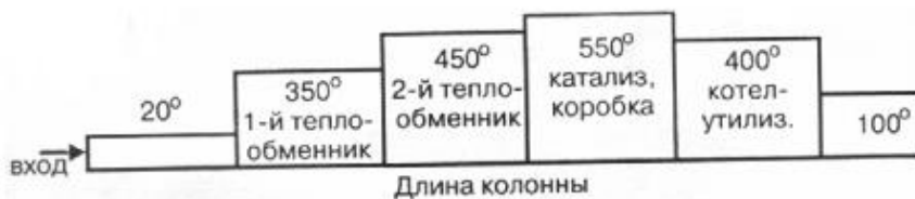
Рисунок 2.13 – График изменения температур в колонне синтеза
