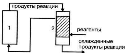
Рисунок 10.4 – Использование тепловых ВЭР в схеме с теплообменником:
