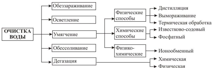
Рисунок 11.5 – Схема промышленной водоподготовки
