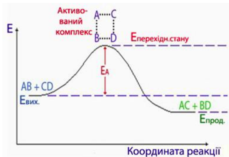
Рисунок 4.7 – Енергетична діаграма реакції AB+CD \rightarrow AC+BD , де E_A – енергія активації, E_{вих.} і E_{прод.} – середня енергія вихідних реагентів і продуктів реакції відповідно
