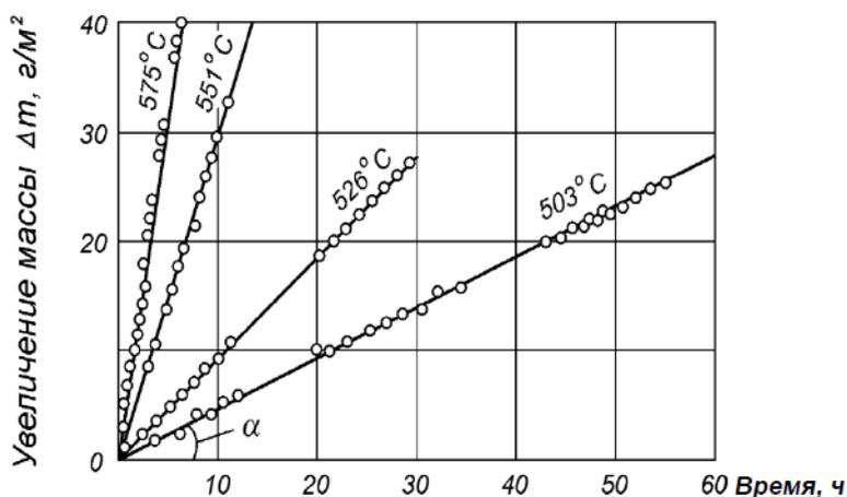
Рисунок 3 – Коррозия магния в среде кислорода при различных температурах
