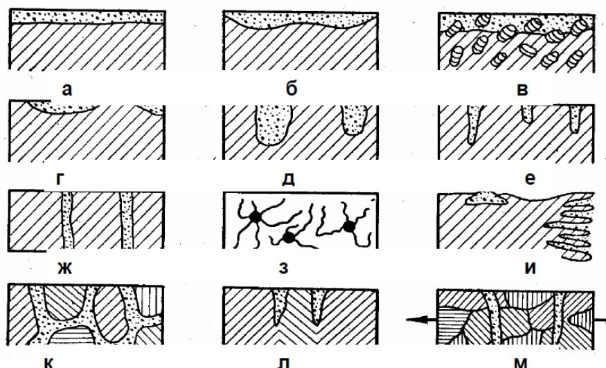
Рисунок 1 – Основные типы разрушения металлов
