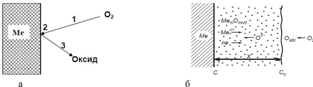
Рисунок 2. Схема взаимодействия кислорода с металлом: а – при тонкой или пористой пленке; б – при сплошной пленке
