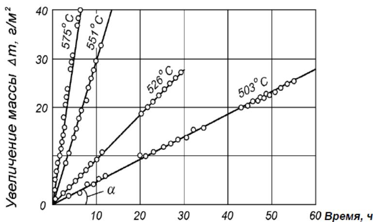
Рисунок 3 – Коррозия магния в среде кислорода при различных температурах
