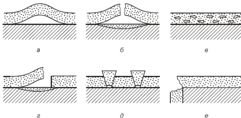
Рис 1. Виды разрушений оксидных пленок при их росте на металлах.
