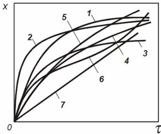
Рисунок 4 – Типичные кривые законов роста пленок на металлах.
