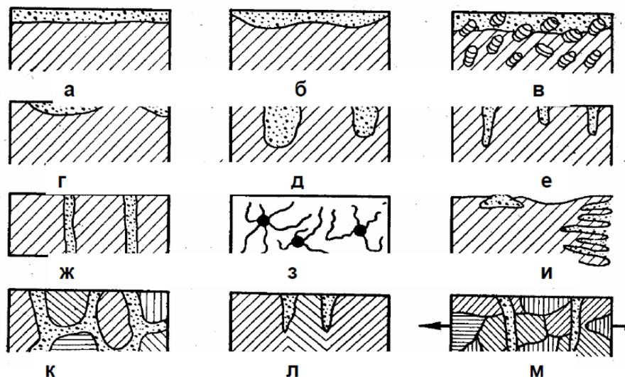
Рисунок 1 – Основные типы разрушения металлов
