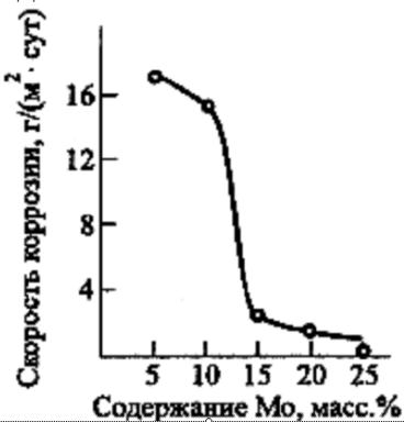
Рисунок 1 – Зависимость скорости коррозии сплава Ni–Mo в 10% HCl при 70°C от содержания молибдена
