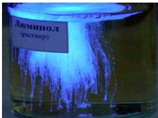
Рисунок 2.13 – Приклад фотохімічної реакції при взаємодії складної органічної сполуки люмінолу \text{C}_8\text{H}_7\text{N}_3\text{O}_2 з окисником у лужному середовищі
