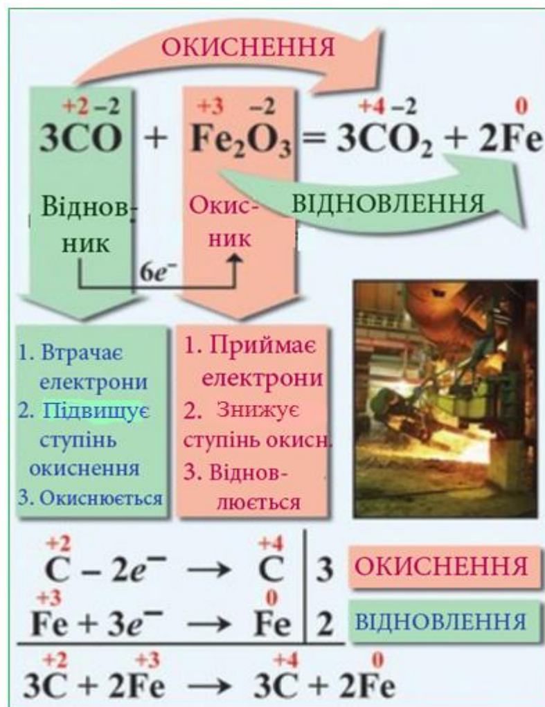
Рисунок 2.18 – Взаємозалежність процесів окиснення та відновлення
