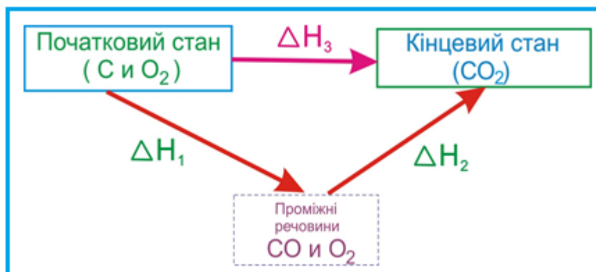
Рисунок 6.11 – Теплові ефекти реакцій утворення CO_2 двома способами
