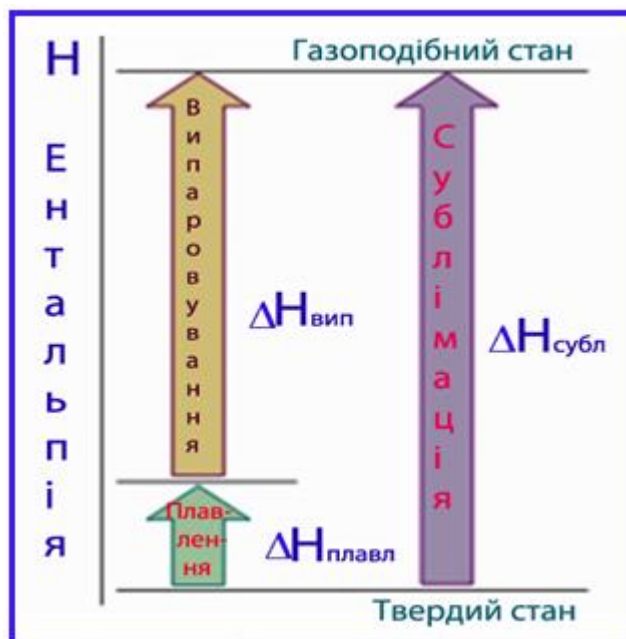
Рисунок 6.10 – Теплові ефекти фазових переходів
